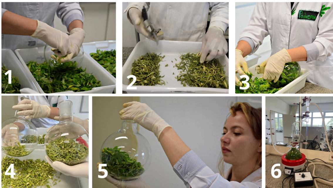
Fotos: 1. Folhas picadas; 2. Hastes picadas; 3. Folhas colocadas dentro do balão; 4. Hastes colocadas dentro do balão; 5. Folhas no balão de extração; 6. Aparelho de Clevenger pronto para extração. Fonte: elaborada pelos autores.
